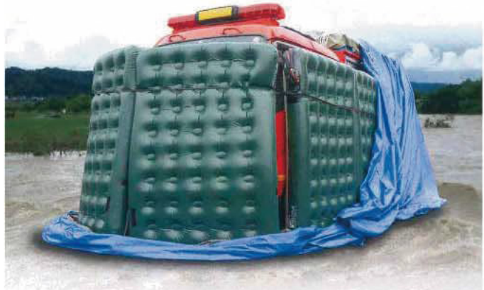
エアマット ・浮遊物の衝突による損傷を防ぐとともに車体の浮力を保ちます
