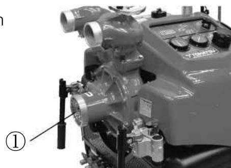
2. Ziehen Sie den Ansaughebel, um den Einspritzer zu starten, und kontrollieren Sie, ob der Zeiger der Druckanzeige für die Ansaugung etwa -0.8 bar anzeigt.
