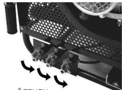
7. Öffnen Sie die Ablassventile, um sie der Atmosphäre auszusetzen, und kontrollieren Sie, ob der Zeiger der Druckanzeige für die Ansaugung zu "0" zurückkehrt.
