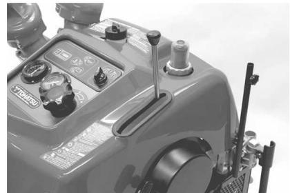
5. Kontrollieren Sie, ob der Vakuumdruck der Druckanzeige für die Ansaugung unter -0.8 bar liegt.
