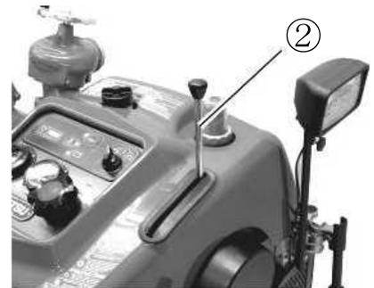
3. Bedienen Sie den Schieberdrehknopf, um den Pumpendruck auf fast 10 bar zu erhöhen, und kontrollieren Sie dann auf Wasserlecks an jedem Teil der Pumpe und der Kühlwasserrohre.
