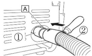
2. Passen Sie die Kerbe [B] der Auspuffrohrverlängerung ② an die Nabe [A] des Schalldämpfer-Auspuffrohrs ① an.
