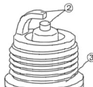
3. Kontrollieren Sie die Zündkerze auf übermäßige Kohlenstoffablagerungen, Elektroden-Abnutzung ② und kontrollieren Sie die Unterlegscheibe ③ auf Schäden.
