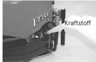
Ein Lüftungsschlitz befindet sich am Kraftstoffeinfüllstutzen.
