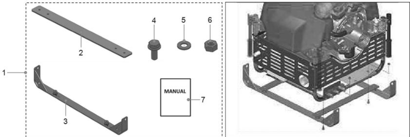
Das TRANSPORTGERÄT (TRANSPORTRAHMENSATZ) besteht aus den folgenden Teilen. Sie können nur die Teile mit Teilenummern nachbestellen.
