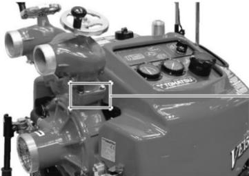
Die Identifikationsnummer der Pumpe ist auf dem Pumpengehäuse gekennzeichnet.
