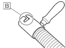
3. Drehen Sie den Griff, um die Auspuffrohrverlängerung ② zu befestigen.
