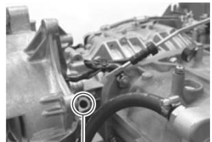
Wlew oleju do skrzyni regulatora
