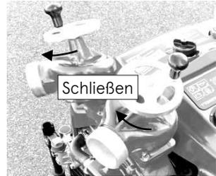
2. Starten Sie den Motor und ziehen Sie am Entlüftungshebel, um die Unterdruckpumpe zu starten. Schließen Sie nach dem Ansaugen von Wasser die Druckventile.
