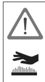
Tragen Sie stets feuerfeste Schutzhandschuhe, wenn Sie die Auspuffschlauchverlängerung des Schalldämpfers berühren.
