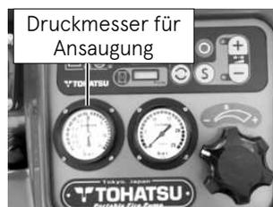
Wenn ein Unterdruckleck festgestellt wird, bestimmen Sie die Ursache mithilfe der Anweisungen aus „Kapitel 16 FEHLERBEHEBUNG“. Ergreifen Sie dann die entsprechenden Maßnahmen und überprüfen Sie das Unterdruckleck erneut.
