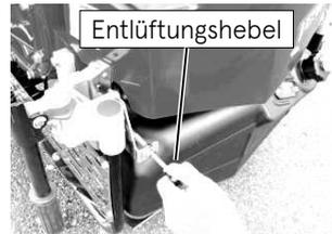
3. Bedienen Sie den Drosselregler, um den Pumpendruck auf knapp 10 bar zu erhöhen, und prüfen Sie dann an allen Teilen der Pumpe, ob Wasserlecks vorhanden sind.
