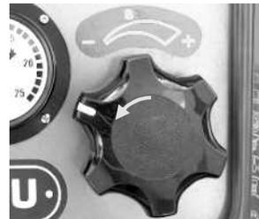
2. Schließen Sie die Druckventile.
