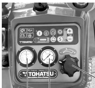
Ciśnieniomierz – tłoczenie Ciśnieniomierz – ssanie
