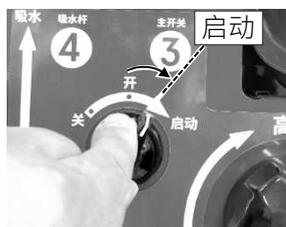
7. 启动发动机后，通过操作吸水杆吸入防冻液。
