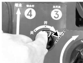
**注** · 起动机长时间工作将耗尽蓄电池的电量。在最多 3 秒内操作起动机。
