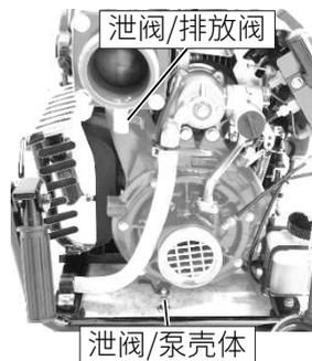
2. 关闭排放阀的泄阀。盖上吸水口盖。
