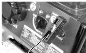
5. 在发动机启动后，慢慢将起动手柄返回到原始位置。不要让起动手柄断掉，否则可导致起动器反冲。
