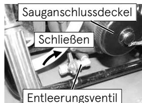
2. Drehen Sie den Drosselregler in die Saugposition. Starten Sie den Motor Heben Sie den Entlüftungshebel an, um die Unterdruckpumpe zu betreiben, und prüfen Sie, dass der Saugdruckmesser ca.  $-0,08 \text{ MPa}$  ( $-0,8 \text{ bar}$ ) anzeigt. Legen Sie den Entlüftungshebel an seine ursprüngliche Position zurück.
