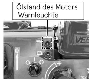
**Wenn der Motor jedoch für länger als diesen Zeitraum betrieben wird, kann er blockieren. Füllen Sie sofort Öl nach, wenn die Warnleuchte aufleuchtet oder der Warnsummer ertönt.**
