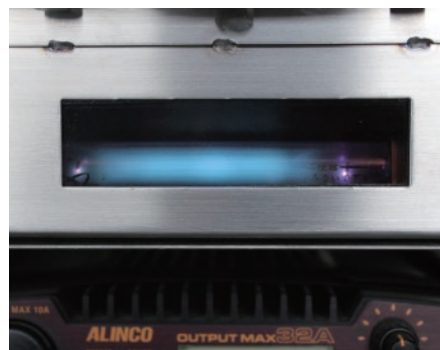
19 患者搬送後は、陰圧装置内の除菌のため紫外線殺菌灯を15分間点灯します。
