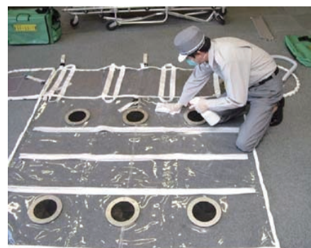
20 ビニールフードは展開して消毒作業が簡単に行え時間や費用の節約になります。※12~15ページの消毒手順書に従って作業して下さい。
