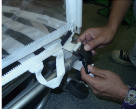
12 組上げたカプセルをストレッチャーに乗せて付属の固定バンドを閉める。
