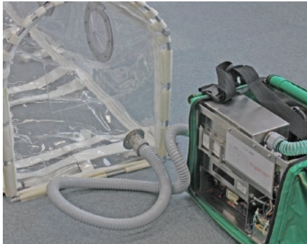
11 カプセル側吸引ホースと除菌装置を結合して搬送準備完了。組立は一人でも数分で可能。
