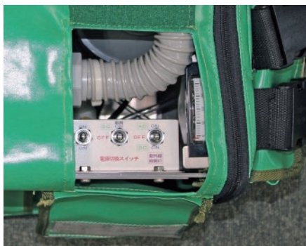
15 除菌装置のスイッチをONにして作動させます。
