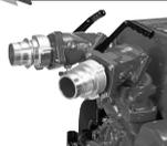
吐水口を2つ設けることで、それぞれ任意の方向へ2線同時放水が可能になりました。2線放水時の放水量は、放水圧0.6MPaで実質2000L/minと、大放水領域に対応しています。
