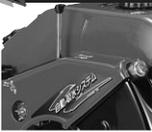
エンジン始動後の真空ポンプ操作を自動化し、省力化を図りました。万が一、吸水が不可能な場合は、モニターにて吸水不能を表示します。
