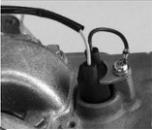
空運転や冷却水不足などによるエンジンの焼付きを防止。万一のトラブル時にはモニターで警告、エンジンは自動停止します。
