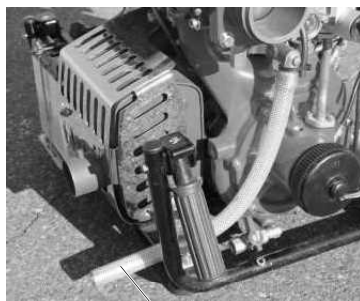
真空ポンプドレンパイプ
