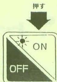
②中継切換スイッチを“中継”側に倒す。
