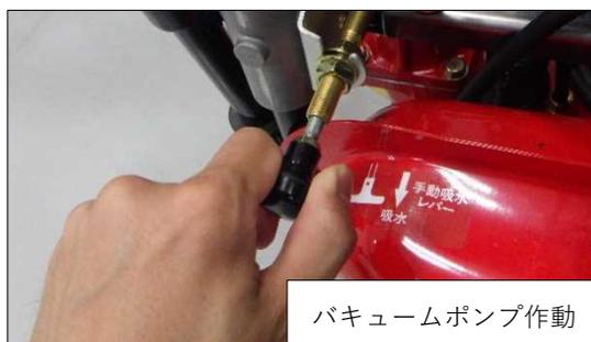
(4) 吸水完了後に再度プライミングバルブを3回握り、不凍液をバキュームポンプに注入します。
