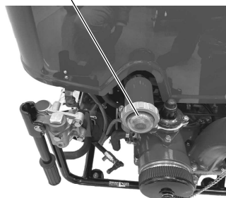
真空ポンプストレーナ
