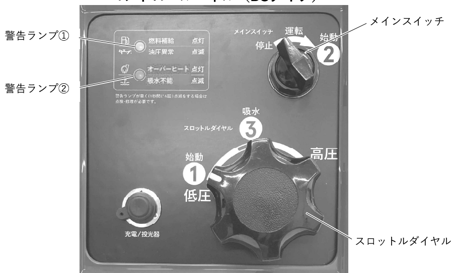
コントロールパネル (BSタイプ)
