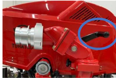
⑤ 吸水切替スイッチは自動吸水のまま、再度エンジンを始動し、スロットルダイヤルを吸水の位置にして、真空ポンプを作動させてください。20 秒後、吸水不能でエンジンが自動で停止します。
