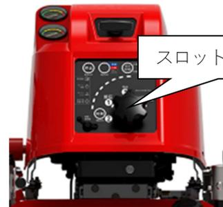
⑥ エンジン停止後、スロットルダイヤルを低圧の位置にしてください。
