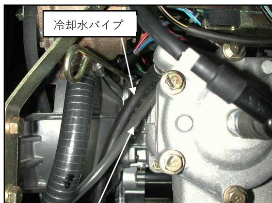
オイルゲージがあるので、シリンダと冷却水パイプの間を通す。
