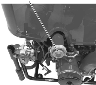
真空ポンプストレーナ
