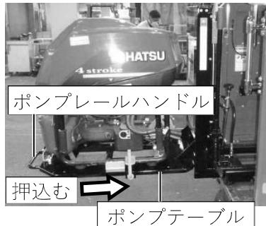
3-4-4 ポンプテーブル固定ピンを固定ピン受けへピンの向きに注意して「パチン」と感触があるまで固定ピンを差し込んでください。
