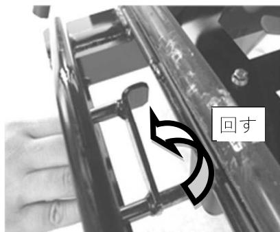
2-2-4 ポンプロックレバーをポンプ側に押し戻し、ロックを解除した状態にします。
