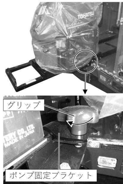
1-3-2 ポンプ固定ブラケットの固定グリップを締めて、ブラケットで可搬消防ポンプをテーブルに固定してください。
