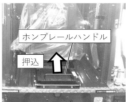
1-4-2 ポンプレールストッパピンを確実に差し込んで、ポンプテーブルとポンプレールを固定してください。
