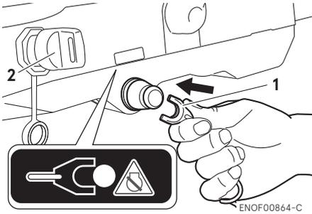
1. Mécanisme de verrouillage de l'interrupteur d'arrêt
