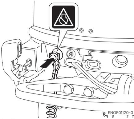
4. Tourner la clé de contact en position OFF ou actionnez l'interrupteur d'arrêt. (Ne pas oublier de mettre la clé de contact sur OFF).
