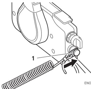
1. Mécanisme de verrouillage de l'interrupteur d'arrêt
