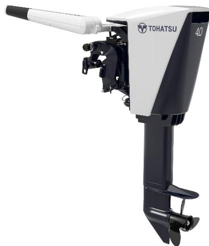
本 4.0 kW 電動船外機プロトタイプは、4ストローク 8馬力船外機と同等の加速性能と推進力を発揮します。また、「誰もが直感的に使用出来る事」を設計理念に、シフトイングリップによる加減速／前後進操作、カウル上部 LED インジケーター及びティラーハンドル内蔵のフルカラー液晶ディスプレイにて、バッテリー残量、走行速度、航続距離並びに航続可能時間の確認を可能にし、ユーザーエクスペリエンス向上に最大限配慮しました。
