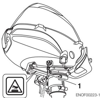
1. Orifice de contrôle de l'eau de refroidissement
