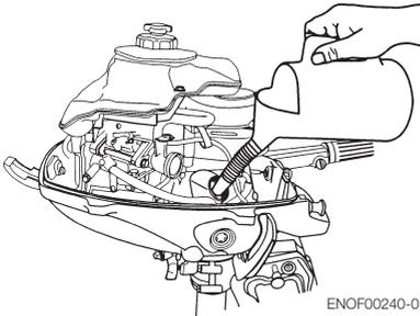
Utilisez uniquement de l'huile moteur 4 temps de haute qualité pour garantir la performance et la durée de vie du moteur. L'huile SAE de viscosité 10W-30 ou l'huile moteur pour moteur hors-bord 10W-40 est recommandée.
