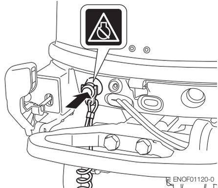
4. Drehen Sie den Zündschlüssel auf die Position OFF oder drücken Sie den Stoppschalter. (Vergessen Sie nicht, den Schlüssel zu deaktivieren).
