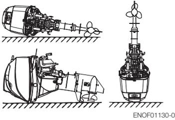
Der Motor muss beim Transport immer aufrecht gelagert werden. Der optionale Ständer für den Außenbordmotor wird empfohlen, um den Außenbordmotor beim Transport und bei der Lagerung vertikal zu halten.
