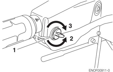
1. Tornillo de ajuste de la fricción del acelerador
