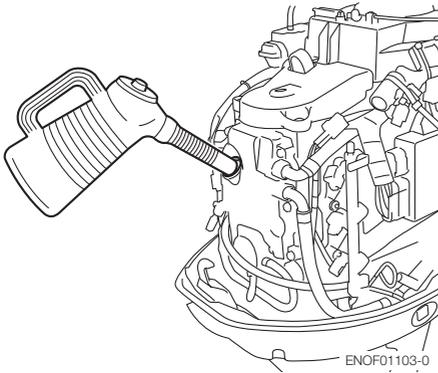
Utilice únicamente aceite de motor de 4 tiempos de gran calidad para garantizar el rendimiento y una vida útil prolongada del motor.
