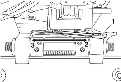
1. Palanca de fricción de la dirección
