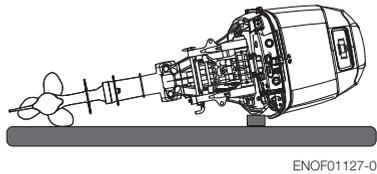
**8** Al transportar el motor fueraborda manténgalo en una posición vertical. Se recomienda usar el soporte opcional del motor fueraborda para mantenerlo en posición vertical tanto durante el transporte como en el almacenamiento.
