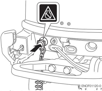
4. Gire la llave del interruptor principal hasta la posición OFF o presione el interruptor de parada. (No olvide girar la llave hasta la posición OFF).
