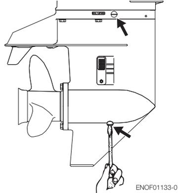
3. Inserte la boquilla del tubo de aceite en el orificio del tapón inferior y llénelo con aceite de engranajes apretando el tubo de aceite hasta que salga aceite por el orificio del tapón superior y las burbujas hayan desaparecido para eliminar el aire.
