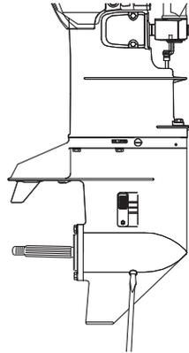
3. Introduisez l'injecteur du tube d'huile dans l'orifice du bouchon d'huile inférieur et remplissez le réservoir avec de l'huile pour embase en appuyant sur le tube jusqu'à ce que l'huile atteigne l'orifice du bouchon d'huile supérieur.
