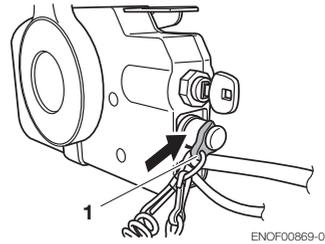
1. Mécanisme de verrouillage de l'interrupteur d'arrêt
