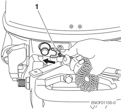
1. Mécanisme de verrouillage de l'interrupteur d'arrêt
