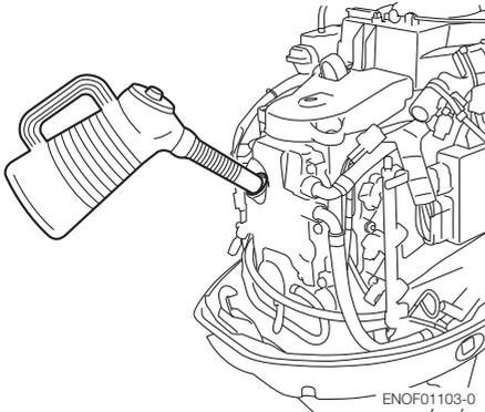
Utilisez uniquement de l'huile moteur 4 temps de haute qualité pour garantir la performance et la durée de vie du moteur. L'huile SAE de viscosité 10W-30 ou l'huile moteur pour moteur hors-bord 10W-40 FC-W est recommandée.
