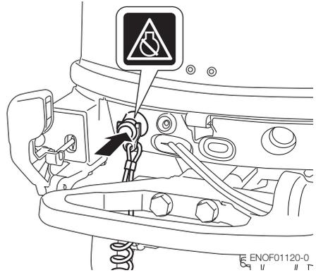
3. Tourner la clé de contact en position OFF ou actionnez l'interrupteur d'arrêt. (Ne pas oublier de mettre la clé de contact sur OFF).
