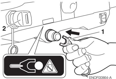
1. Mécanisme de verrouillage de l'interrupteur d'arrêt
