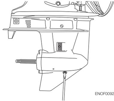
3. Inserte la boquilla del tubo de aceite en el orificio del tapón inferior y llénelo con aceite de engranajes apretando el tubo de aceite hasta que salga aceite por el orificio del tapón superior y las burbujas hayan desaparecido para eliminar el aire.
