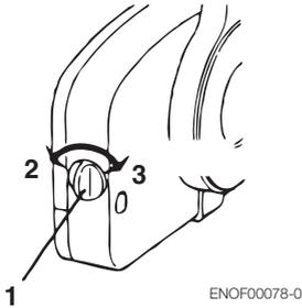
1. Tornillo de ajuste de la fricción del acelerador
